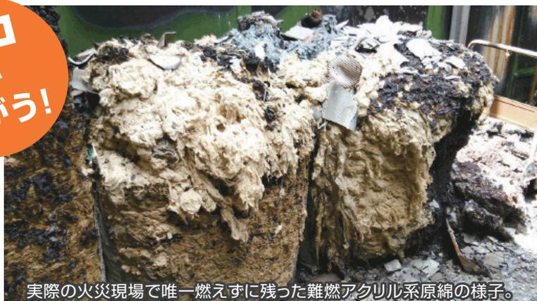
実際の火災現場で唯一燃えずに残った難燃アクリル系原綿の様子。
